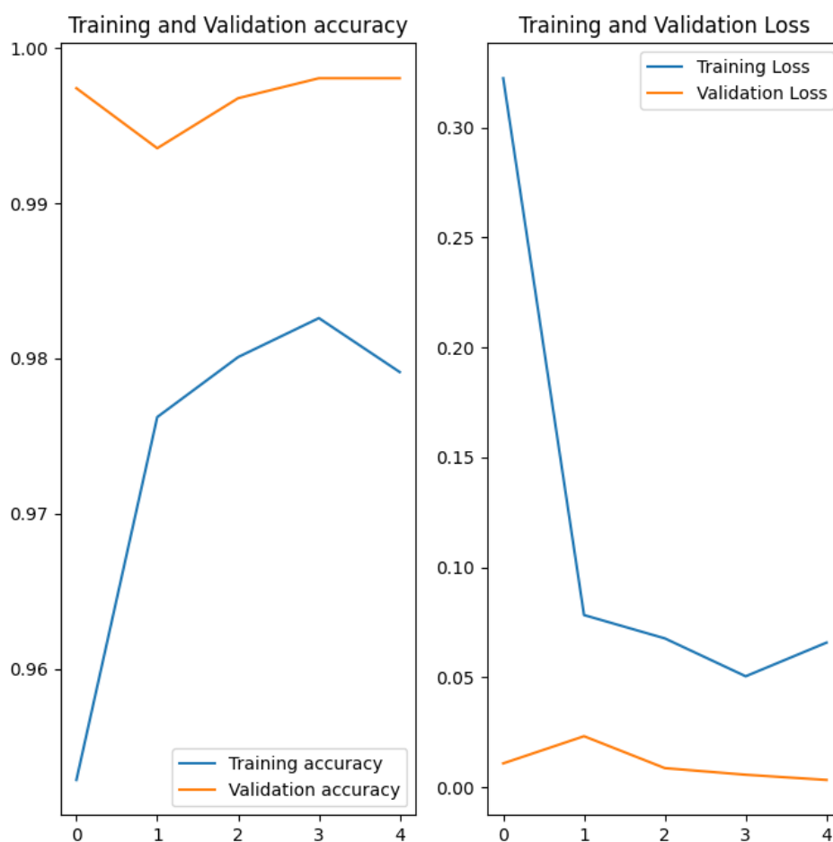
Figura 11 – Acurácia e taxa de aprendizado para EfficientNetB3 em relação a treino e validação.
