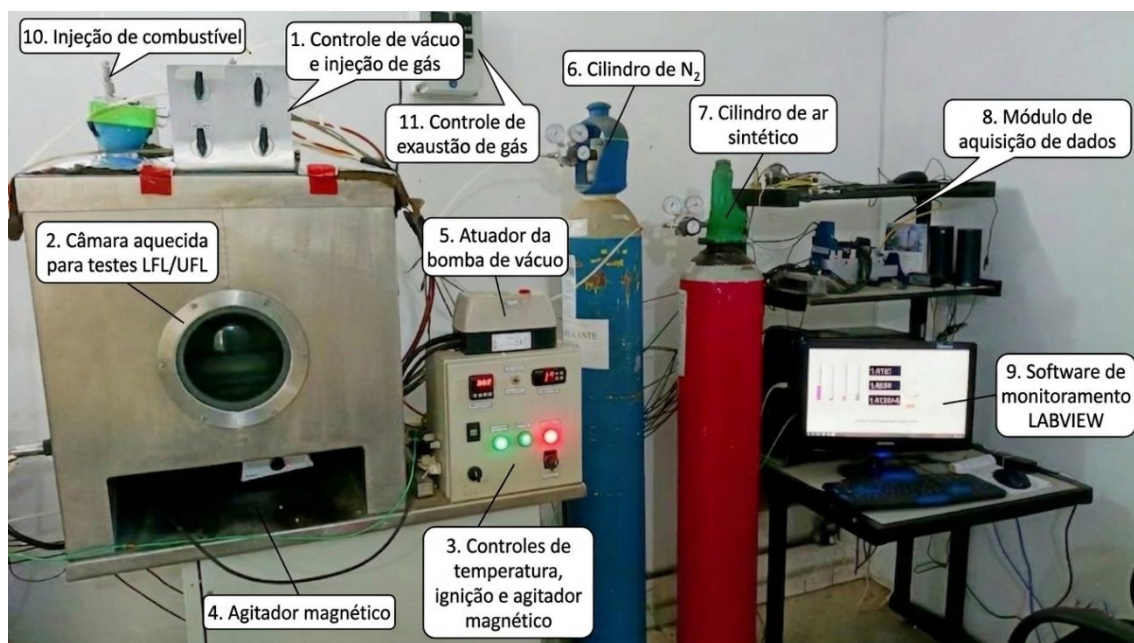
Figura 1: Configuração experimental para teste de inflamabilidade do HVO. (fonte: o autor)
